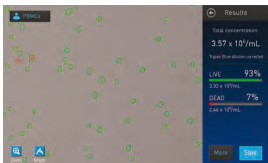
Рисунок 1. Подсчёт клеток МКПК с помощью автоматического счётчика клеток Countess II. Подсчёт клеток и оценка их выживаемости могут быть произведены с помощью стандартной окраски трипановым синим. На дисплее отображены данные о количестве клеток, а также о соотношении живых и мёртвых клеток.
