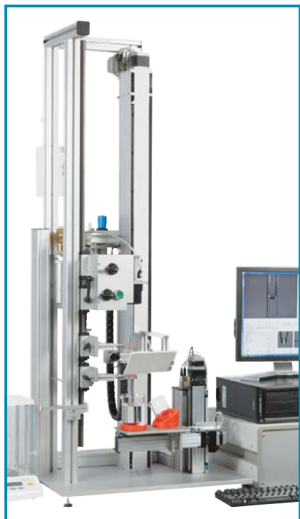
Такие процедуры, как заполнение водой, нахождение линии мениска и контроль объема, выполняются автоматически.
