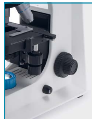
Грубая и точная настройка выполняются с ограничением верхнего предела с мелким делением 0,002 мм и максимальным ограничением перемещения 20 мм.
