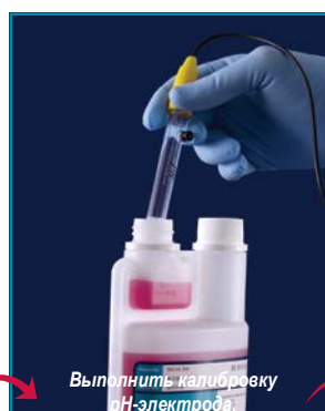
Заполнить калибровочную камеру буферным раствором, осторожно сжав бутылку.
