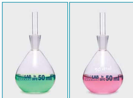
Номинальный объем с 0,001 мл выгравирован на корпусе калиброванных пикнометров.
