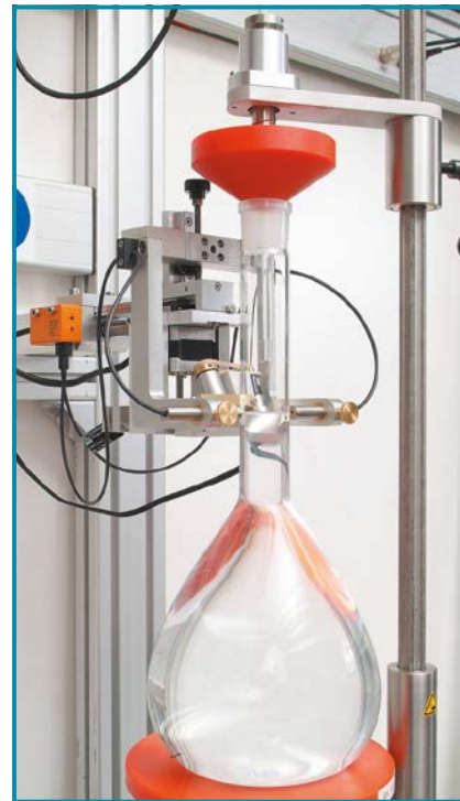
Наполнение заготовок водой выполняется автоматически калибровочными машинами.
