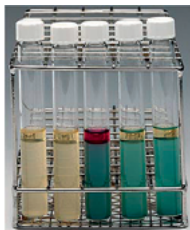
Иллюстрация: Бульон Fluorocult® LMX (слева и справа) Пробирки 1 и 2 S. enteritidis Пробирка 3 E. coli Пробирка 4 C. freundii Пробирка 5 Ent. cloacae
