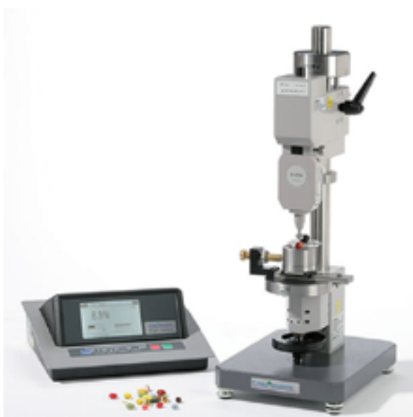
Измерение прочности геля на твердомере Gelomat
