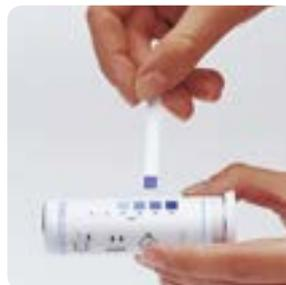
По истечении указанного времени реакции (максимум 1 минута), сравните цвет реакционной зоны со шкалой цветности, напечатанной на этикетке тубы, для определения концентрации.
