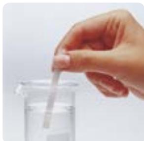
Погрузите тест-полоску в исследуемый раствор для увлажнения реакционной зоны. Удалите лишнюю жидкость, встряхнув полоску или проведя ею по краю сосуда.
